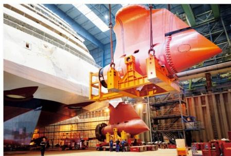
D.P.S.の重要な役割を担うPOD電気推進装置を設置
